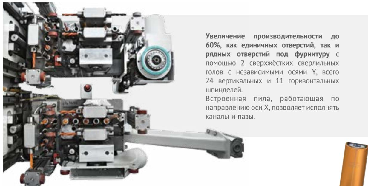
Увеличение производительности до 60%, как единичных отверстий, так и рядных отверстий под фурнитуру с помощью 2 сверхжестких сверлильных голов с независимыми осями Y, всего 24 вертикальных и 11 горизонтальных шпинделей. Встроенная пила, работающая по направлению оси X, позволяет исполнять каналы и пазы.
