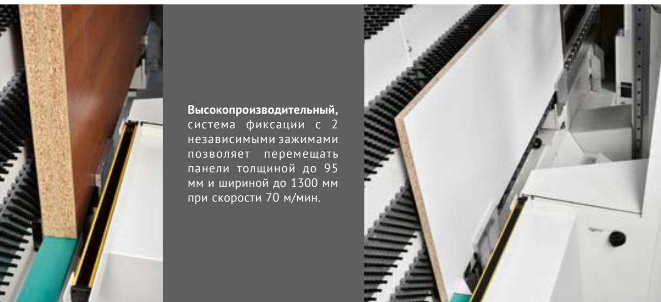
**Высокопроизводительный,** система фиксации с 2 независимыми зажимами позволяет перемещать панели толщиной до 95 мм и шириной до 1300 мм при скорости 70 м/мин.
