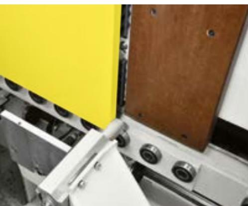
**Высокий уровень гибкости,** программируемый базирующий упор позволяет обрабатывать даже детали с уже установленными шкантами или криволинейной формой.
