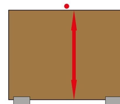
**Отсутствие ошибок при загрузке панелей с измерительным датчиком по Y,** который проверяет соответствие размеров введённой панели с заданными в программе размерами.
