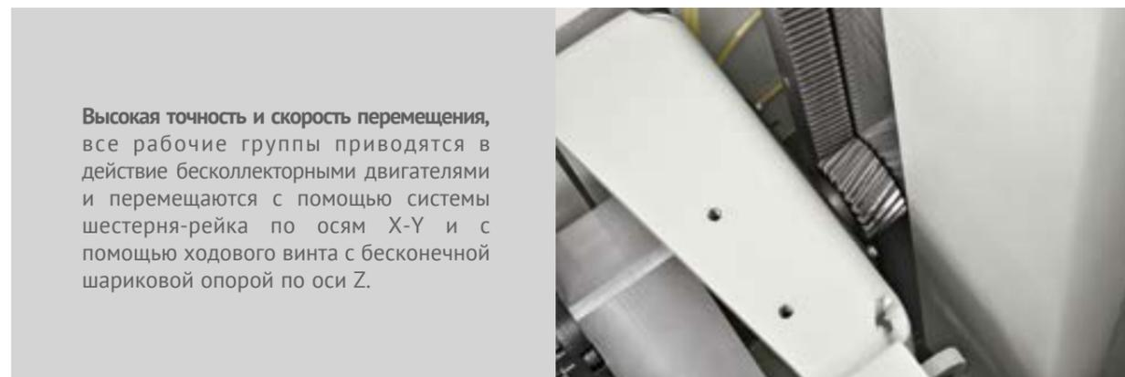
Высокая точность и скорость перемещения, все рабочие группы приводятся в действие бесколлекторными двигателями и перемещаются с помощью системы шестерня-рейка по осям X-Y и с помощью ходового винта с бесконечной шариковой опорой по оси Z.
