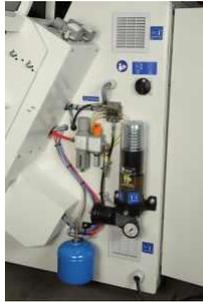
Всегда поддерживается нужный уровень смазки на движущихся частях станка благодаря электронной системе контроля
