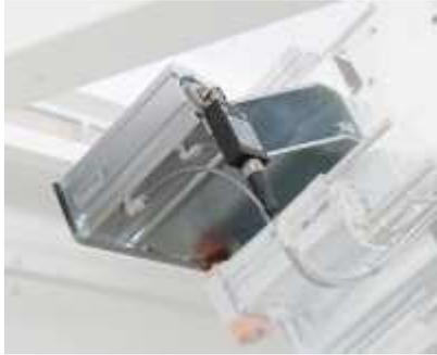
Упор для заготовок расположен на сверлильной голове. При программировании начального положения сверлильной головы возможно расположить нулевой упор в нужном положении, чтобы избежать возможного соударения со шкантами или радиусным закруглением.
