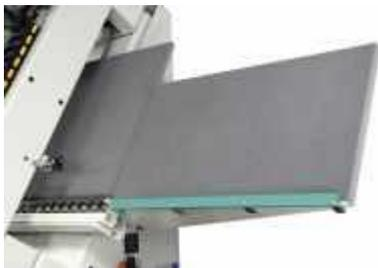
Данные опоры поддерживают длинную заготовку на входе/выходе из станка
